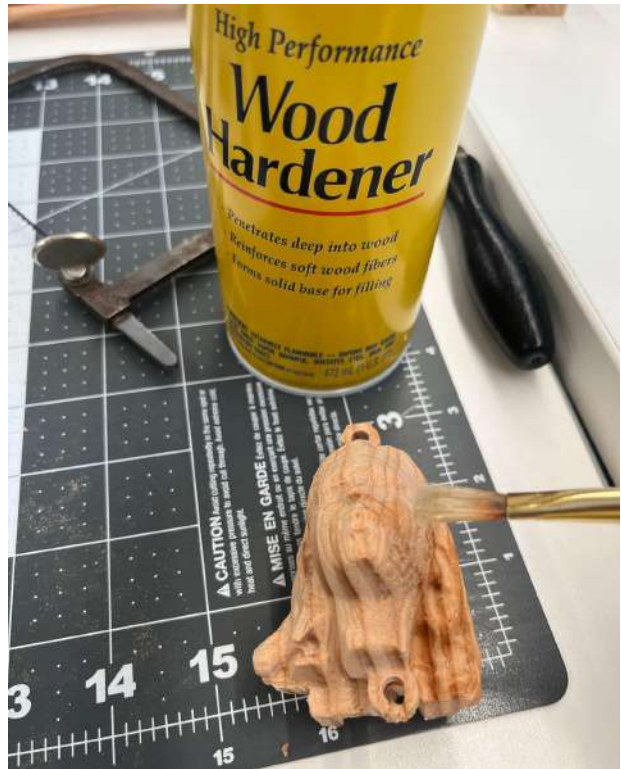
Adding a layer of wood hardener (img. 54)
